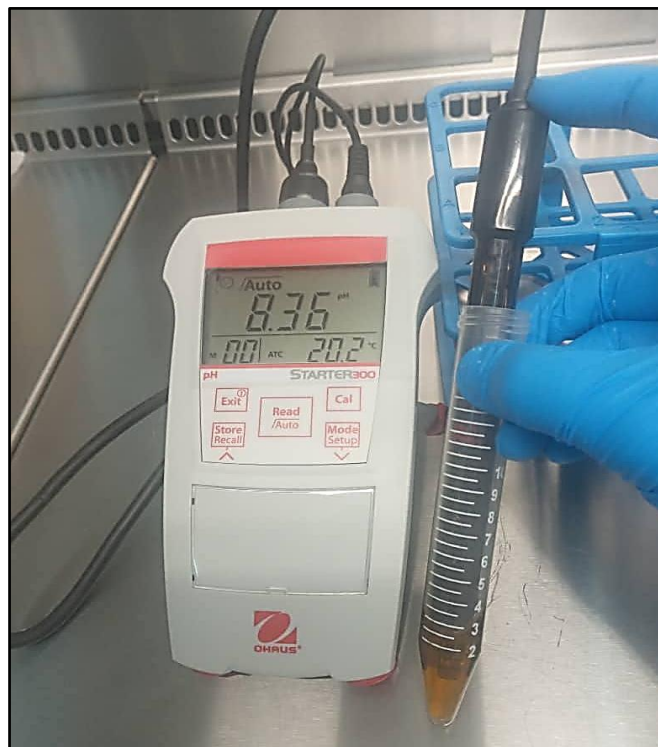
Figure 21. Mesure du pH du sérum bovin jeune à l'aide d'un pH-mètre.
